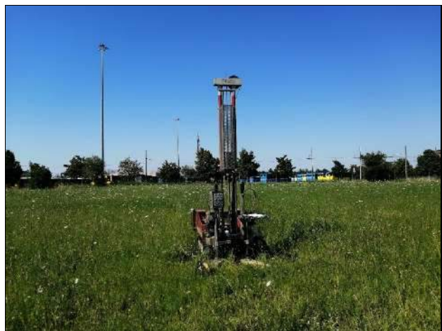
Figura 6c-d: immagini della prova penetrometrica CPT3 e CPT4
